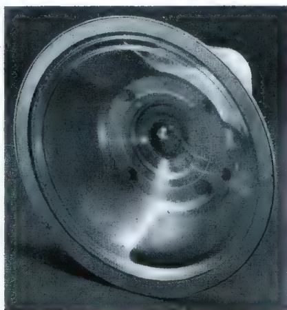
Bild 1. Vorderansicht eines feuchtigkeits- und temperaturbeständigen Tropodynamischen Lautsprechers mit Kunststoffmembran; die Membran ist durchsichtig und läßt das Magnetsystem mit dem Luftspalt erkennen.
